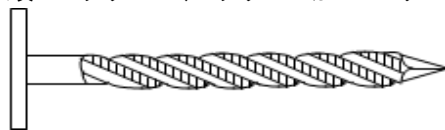
大平頭 スクリュー(スクリュー加工+リング加工)
